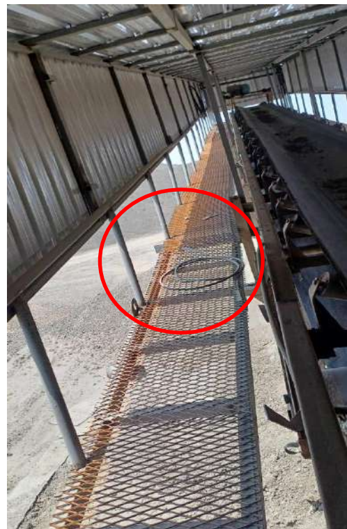
รูปที่ 8 ระบบเปรี๊ยน้ำบริเวณจุดที่เกิดฝุ่นละอองทั้งภายในและรอบบริเวณโรงโม่หิน
