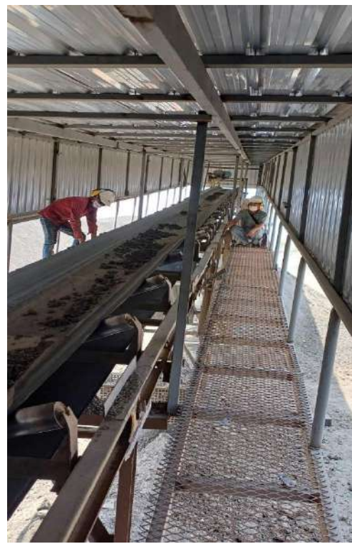
รูปที่ 7 ปิดคลุมโรงโม่หิน และระบบสายพานลำเลียงทั้งหมดด้วยเมทัลชีส
