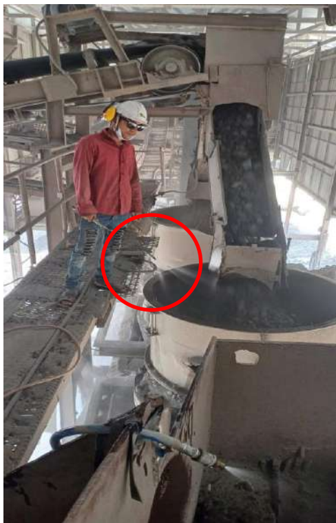
รูปที่ 8 ระบบเปรี๊ยน้ำบริเวณจุดที่เกิดฝุ่นละอองทั้งภายในและรอบบริเวณโรงโม่หิน
