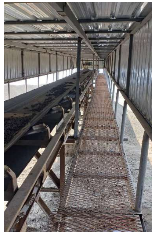
รูปที่ 7 ปิดคลุมโรงโม่หิน และระบบสายพานลำเลียงทั้งหมดด้วยเมทัลชีส
