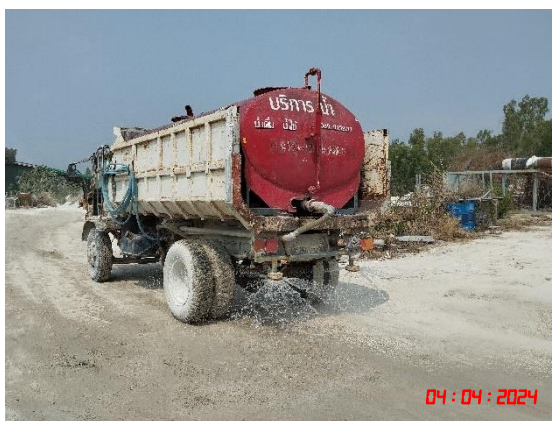
รูปที่ 6 การฉีดพรมน้ำบริเวณเส้นทางขนส่งแร่
