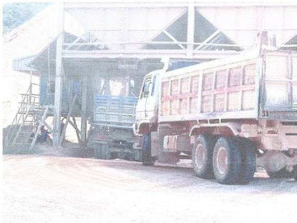
รูปที่ 19 การออกแบบยังเก็บหิน เพื่อลดการฟุ้งกระจายของฝุ่นหินจากปลายสายพาน
