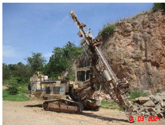
รูปที่ 15 รถเจาะรูระเบิดที่มีอุปกรณ์เก็บฝุ่นติดไว้กับหัวเจาะ
