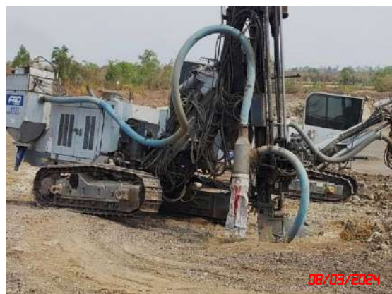
รูปที่ 24 เครื่องเจาะรูระเบิดที่มีอุปกรณ์เก็บฝุ่นติดไว้กับหัวเจาะ
