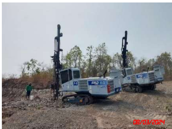
รูปที่ 24 เครื่องเจาะรูระเบิดที่มีอุปกรณ์เก็บฝุ่นติดไว้กับหัวเจาะ
