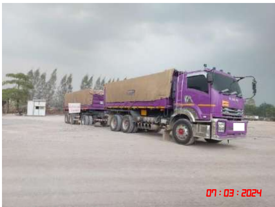
รูปที่ 12 การปิดคลุมผ้าใบกระบะบรรทุกและป้ายเตือนให้ปิดคลุมผ้าใบ
