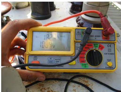
วัดค่าความต้านทานของขดลวดแรงสูง-แรงต่ำ
