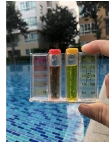
อุปกรณ์ตรวจคลอรีนและ pH
