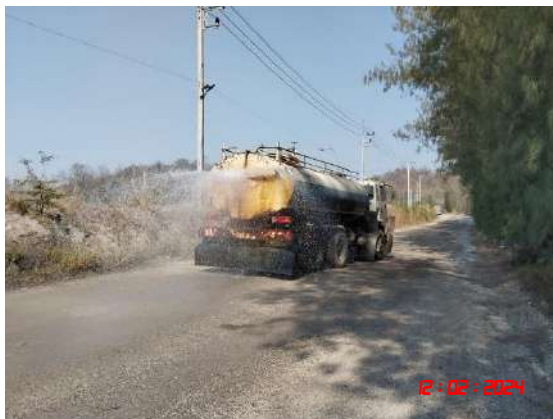
รูปที่ 8 การฉีดพรมน้ำเส้นทางขนส่งแร่
