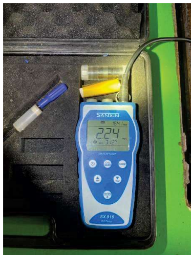
ค่า DO Meter เท่ากับ 2.24 mg/L
