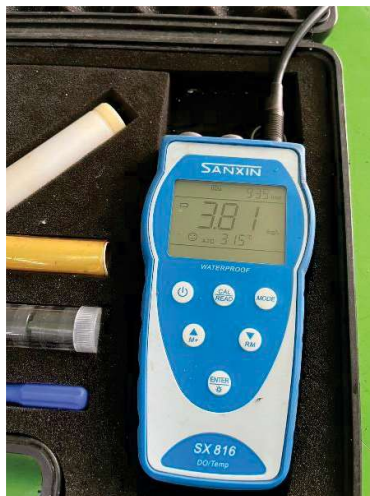
ค่า DO Meter เท่ากับ 3.81 mg/L
