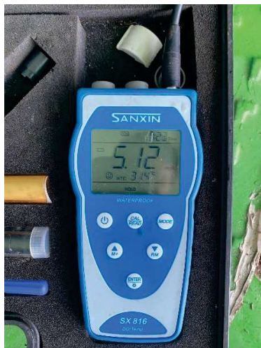
ค่า DO Meter เท่ากับ 5.12 mg/L
