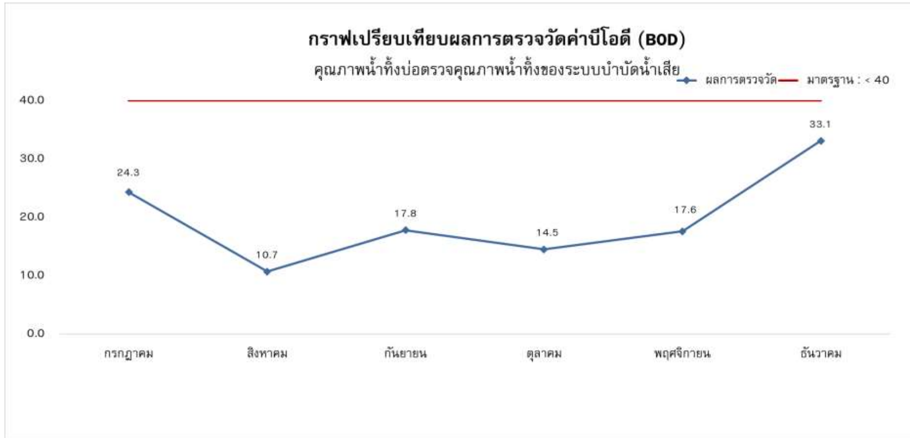
รูปที่ 4.1-2 กราฟเปรียบเทียบผลการตรวจวัดบีโอดี (BOD) บริเวณจุดตรวจวัดคุณภาพน้ำทั้งบ่อตรวจคุณภาพน้ำทั้งของระบบบำบัดน้ำเสีย ระหว่างเดือนกรกฎาคม ถึงเดือนธันวาคม 2566
