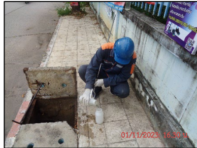
บ่อพักน้ำทิ้งสุดท้ายก่อนระบายออกจากพื้นที่โครงการ
