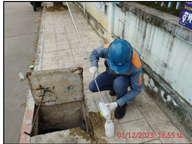
บ่อฟักน้ำทิ้งสุดท้ายก่อนระบายออกจากพื้นที่โครงการ รูปที่ 3-7 แสดงการเก็บตัวอย่างน้ำทิ้ง เดือนธันวาคม 2566
