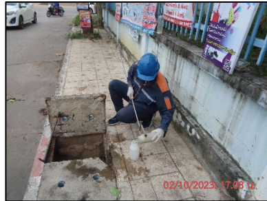
บ่อบำบัดน้ำทิ้งสุดท้ายก่อนระบายออกจากพื้นที่โครงการ รูปที่ 3-5 แสดงการเก็บตัวอย่างน้ำทิ้ง เดือนตุลาคม 2566
