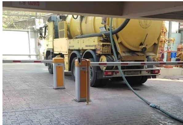
รูปที่ 43 รถสูบล้างอุปกรณ์หน่วยงานเอกชนมาสูบล้างก่อน ส่วนเกินไปกำจัด
