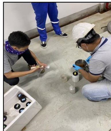
รูปที่ 31 เก็บตัวอย่างน้ำใต้ดินมาวิเคราะห์หาเชื้อ E.coli
