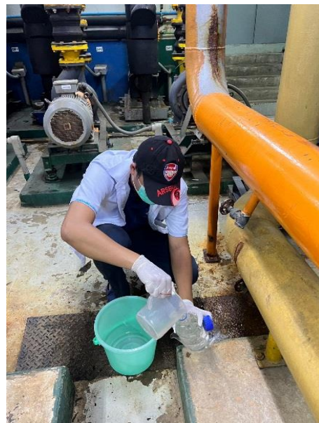
ภาพที่ 72 แสดงภาพขณะเก็บตัวอย่างน้ำ Cooling
