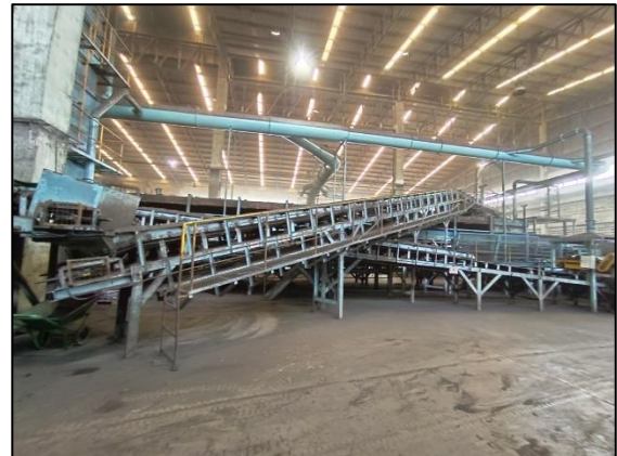
รูปที่ 5 ระบบสายพานแบบปิด
