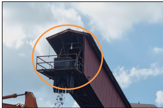
รูปที่ 2-11 การปิดปกคลุมปลายสายพานลำเลียง
