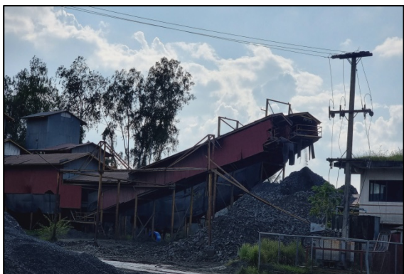
รูปที่ 2-10 การปิดปกคลุมสายพานลำเลียง
