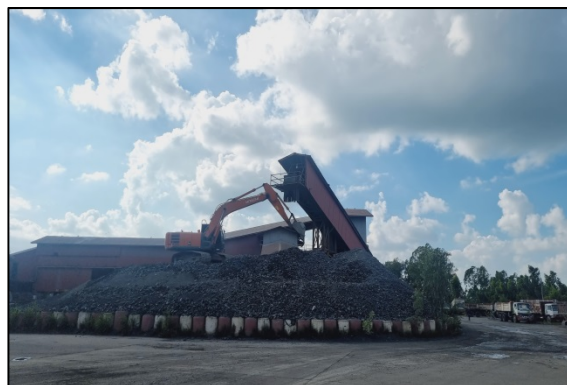
รูปที่ 2-10 การปิดปกคลุมสายพานลำเลียง
