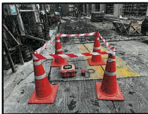
รูปที่ 3-13 ติดตั้งเครื่องวัดความสั่นสะเทือนในพื้นที่ก่อสร้าง
