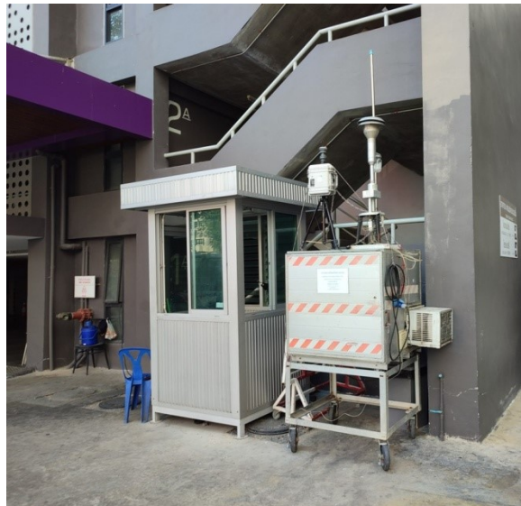
ตรวจวัดฝุ่น (TSP , PM10)และก๊าซ CO , SO2 , NO2 , HC
