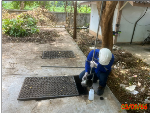
รูปที่ 3.1-9 บ่อพักน้ำเสียก่อนเข้าระบบบำบัดน้ำเสียประจำเดือนกันยายน 2566
