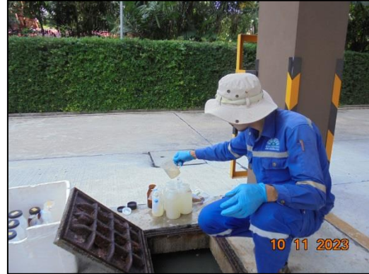
รูปที่ 3.2-3 จุดตรวจวัดคุณภาพน้ำทิ้ง บริเวณน้ำเสียก่อนเข้าระบบบำบัดน้ำเสีย อาคาร 4 ประจำเดือนกรกฎาคม - ธันวาคม พ.ศ. 2566
