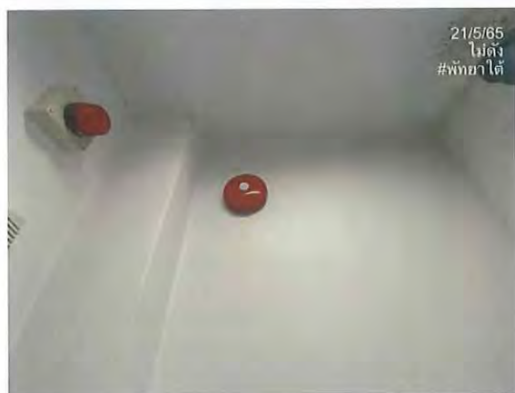
รูปที่ 3.5 ทดสอบ Alarm bell ไม่ดัง
