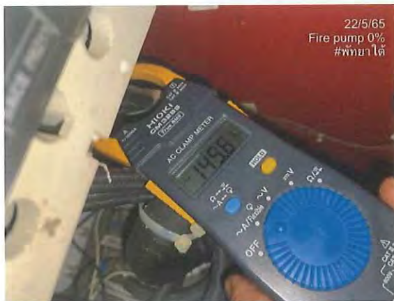
รูปที่ 2.1 ตรวจสอบสภาพทั่วไปของ Fire pump มีสภาพปกติ และทดสอบ start สามารถใช้งานได้
