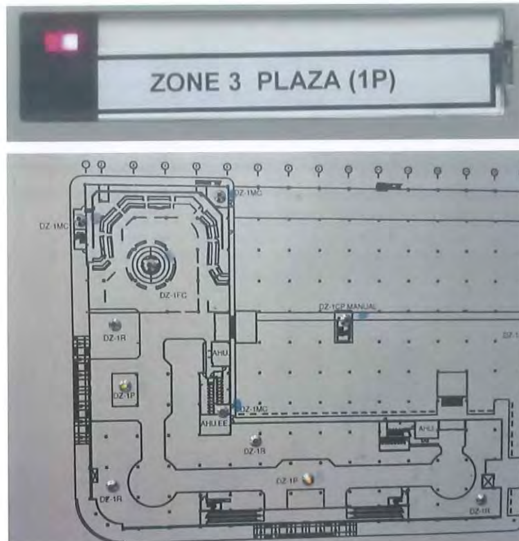
รูปที่ 2.40 ตู้ควบคุม และตู้กราฟฟิกแสดงผลแจ้งเหตุเพลิงไหม้ zone 03(DZ-1P)
