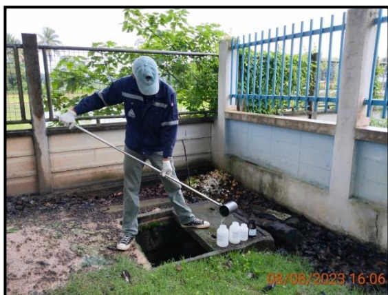
บ่อพักสุดท้ายก่อนระบายออกสู่สาธารณะ
