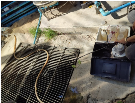
ภาพที่ 4-1 เก็บตัวอย่างน้ำทิ้งที่ปอดตรวจคุณภาพน้ำทิ้งของโครงการ
