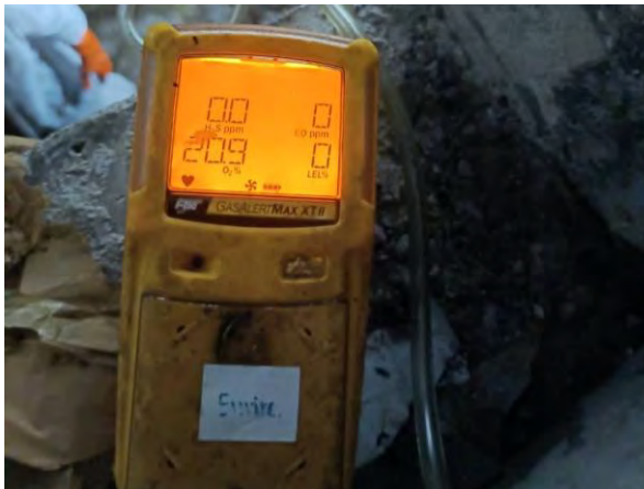
ตรวจวัดคุณภาพอากาศก่อนปฏิบัติงาน - ก่อนล้างทำความสะอาด
