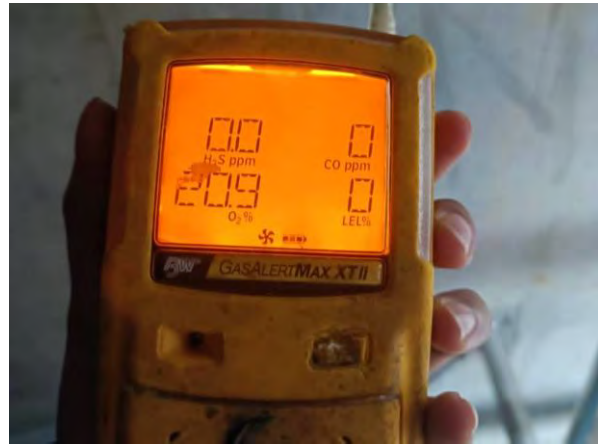
เครื่องแต่งกายขณะปฏิบัติงาน – ตรวจวัดคุณภาพอากาศก่อนปฏิบัติงาน
