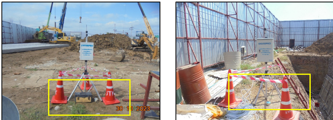
รูปที่ 3.3-1 จุดตรวจวัดความสั่นสะเทือน บริเวณพื้นที่ก่อสร้าง ด้านที่อยู่ใกล้อาคารข้างเคียงมากที่สุด
