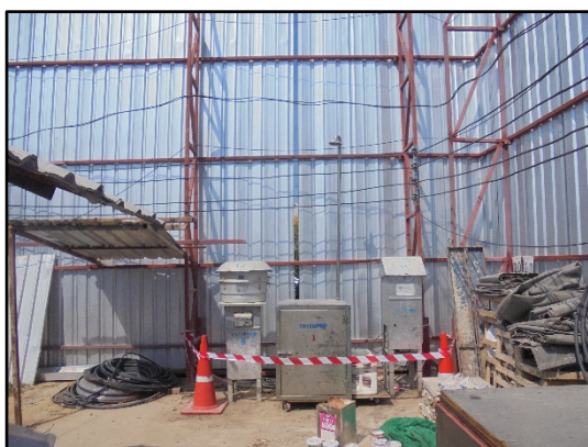
รูปที่ 3.1-1 จุดตรวจวัดคุณภาพอากาศในบรรยากาศทั่วไป บริเวณพื้นที่ก่อสร้าง ด้านที่อยู่ใกล้อาคารข้างเคียงมากที่สุด
