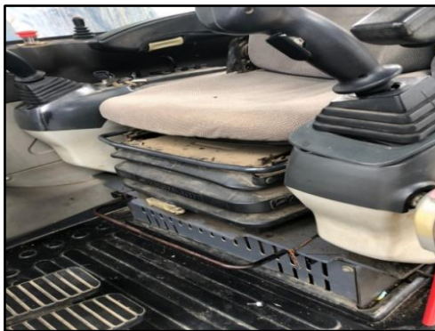
รูปที่ 73 วัสดุป้องกันการสั่นสะเทือน
