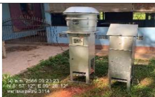
รูป V : ตรวจวัดปริมาณฝุ่นละอองแขวนลอยในบรรยากาศเฉลี่ยในรอบ 24 ชั่วโมงเป็นเวลา 3 วันต่อเนื่อง โดยใช้เครื่อง High Volume Air Sampler จำนวน 2 สถานี
