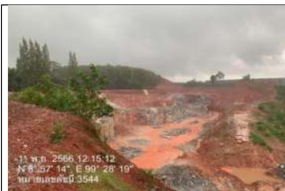
รูป A หน้าเหมืองปัจจุบันที่เป็นชั้นบันไดและเส้นทางลำเลียง
