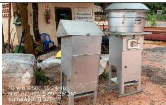
รูป AB ตรวจวัดปริมาณฝุ่นละอองแขวนลอยในบรรยากาศ (TSP) เฉลี่ยในรอบ 24 ชั่วโมงเป็นเวลา 3 วันต่อเนื่อง โดยใช้เครื่อง High Volume Air Sampler จำนวน 4 สถานี
