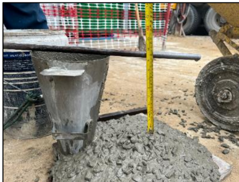
รูปที่ 77 ตรวจวัดค่าการยุบตัว และอุณหภูมิของคอนกรีต
