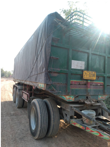
ภาพที่ 5-10 ปิดคลุมกระบะบรรทุกด้วยผ้าใบป้องกันการร่วงหล่นของวัสดุ
