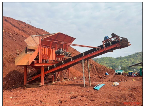
ภาพที่ 2-10 ตะแกรงแบบเคลื่อนที่ได้สำหรับคัดแต่งแร่
