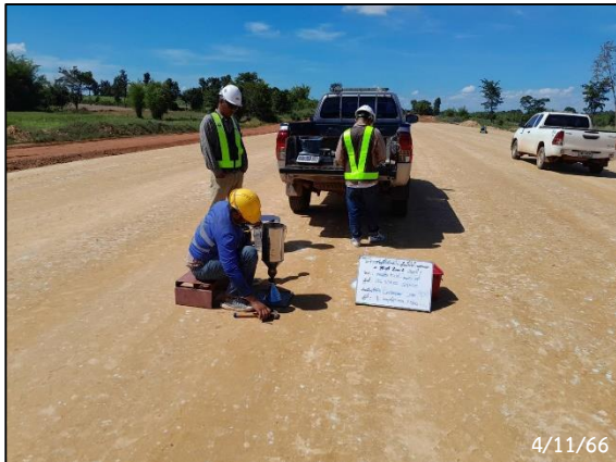
การทดสอบความหนาแน่นของชั้นดิน
