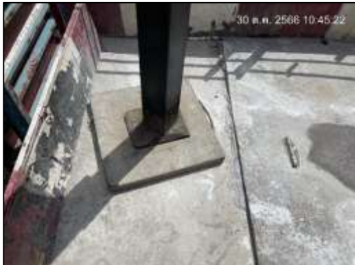
ภาพที่ 58 วัสดุป้องกันการสั่นสะเทือนรองไว้ใต้เครื่องจักร
