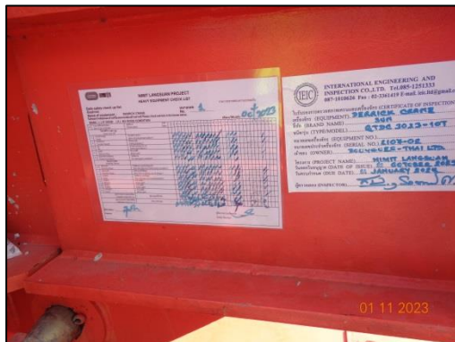
รูปที่ 10 การตรวจสอบเครื่องขนั้ และเครื่องจักรกลต่างๆ
