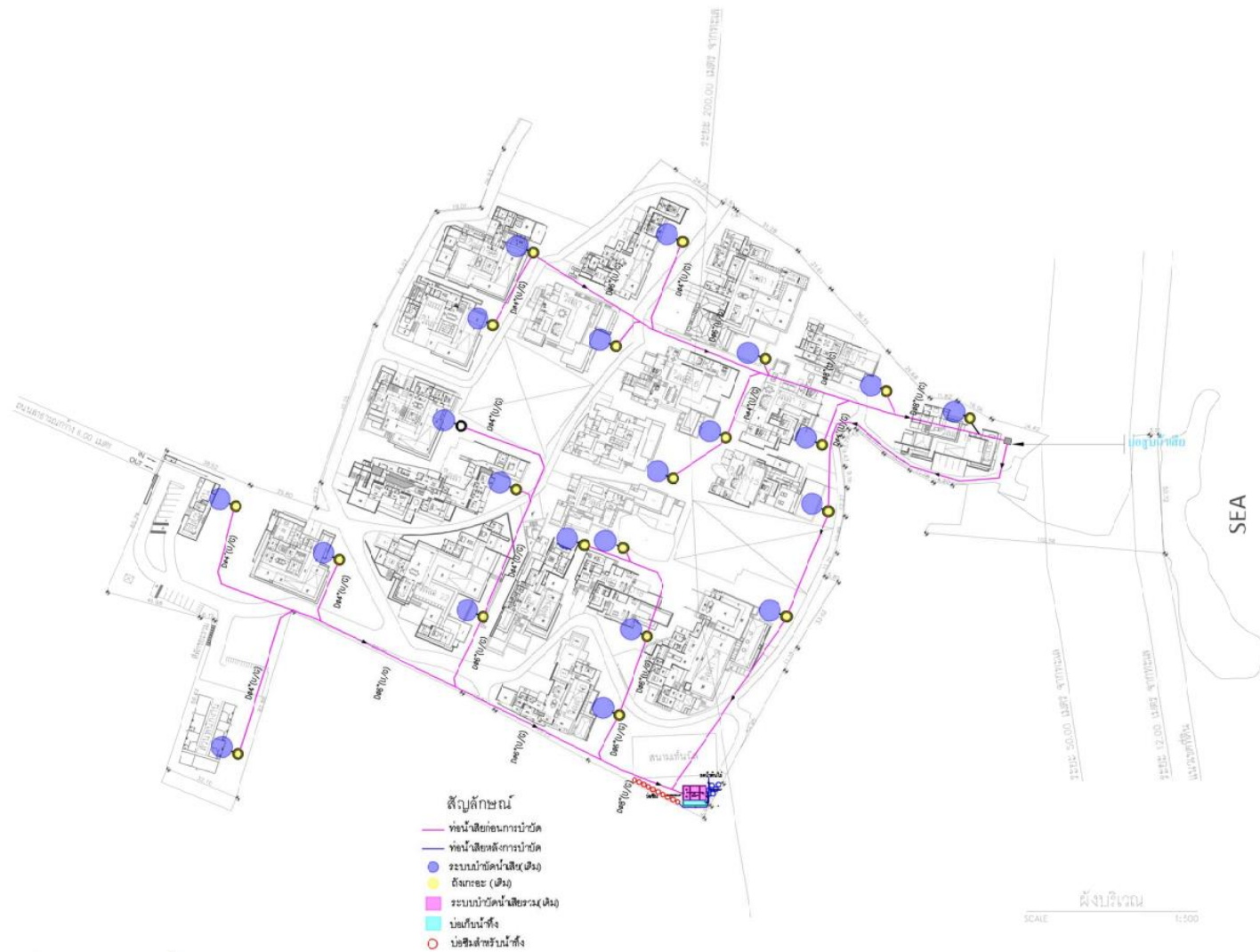
รูปที่ 3.1-2 ผังระบบน้ำเสียของโครงการ
