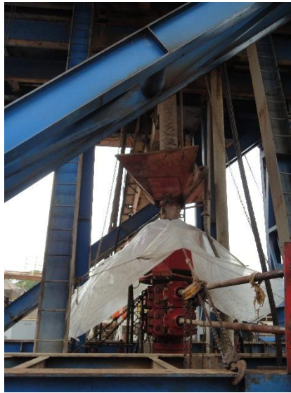
ภาพถ่ายที่ 2.3-1 อุปกรณ์ป้องกันการพลุ่ง (Blowout Preventor, BOP)
