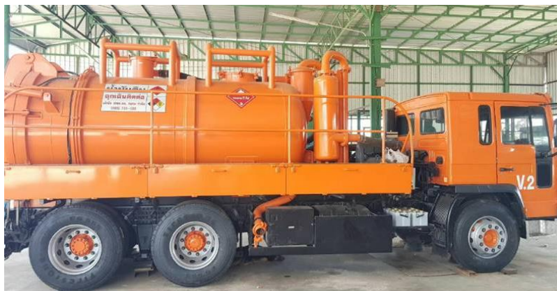
รูปที่ 3-20 ตัวอย่างรถสูบน้ำ (V-truck) จากบ่อคอนกรีตที่รวมรวมน้ำที่อาจเกิดการปนเปื้อน
