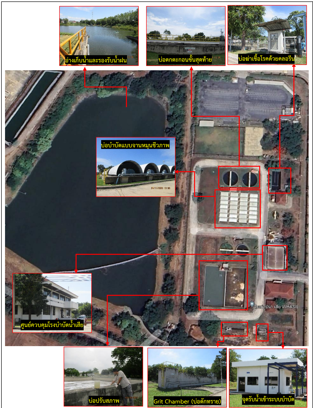
รูปที่ 1.1-4 ระบบบำบัดน้ำเสียในโครงการ
