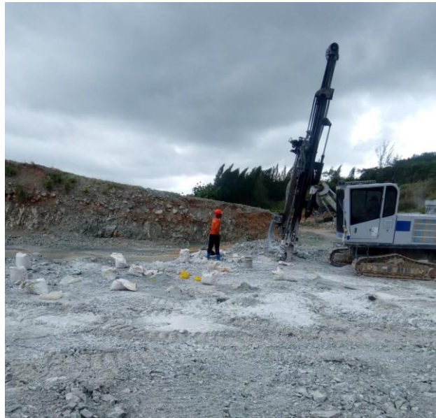
ภาพที่ 2-9 ใช้เครื่องเจาะระเบิด
