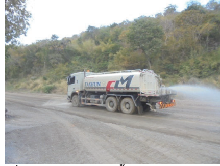
รูปที่ 2-21: การฉีดพรมน้ำบนเส้นทางขนส่งแร่
