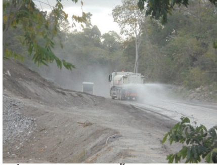
รูปที่ 2-20: การฉีดพรมน้ำบริเวณหน้าเหมือง
