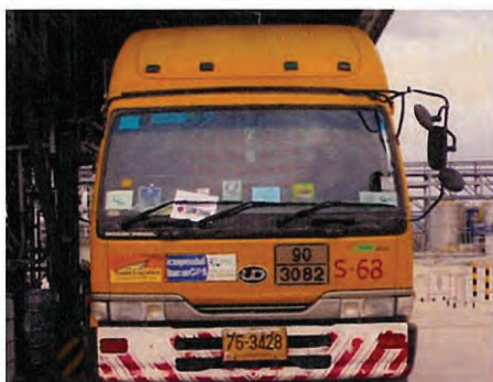
ภาพที่ 2.2-11 รถขนส่งกากของเสียที่ติดตั้งระบบ GPS และติดเบอร์โทรศัพท์ และการติดป้ายความเป็นอันตราย พร้อมอุปกรณ์ระงับเหตุ
