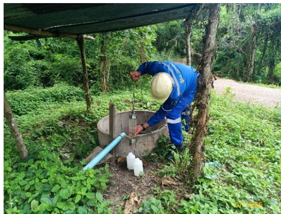
รูปที่ 3 5-1 การเก็บตัวอย่างคุณภาพน้ำใต้ดิน
