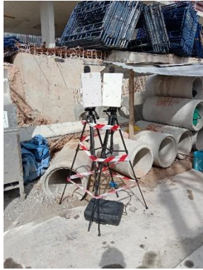
รูปที่ 3.11 แสดงการตรวจวัดระดับเสียง จุดที่ 1 บริเวณพื้นที่โครงการ
