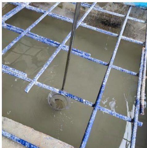
รูปที่ 3.19 การเก็บตัวอย่างคุณภาพน้ำทิ้ง
