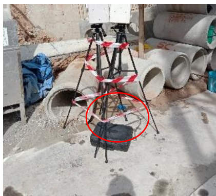
รูปที่ 3.17 การตรวจวัดความสั่นสะเทือน บริเวณภายในพื้นที่โครงการ
