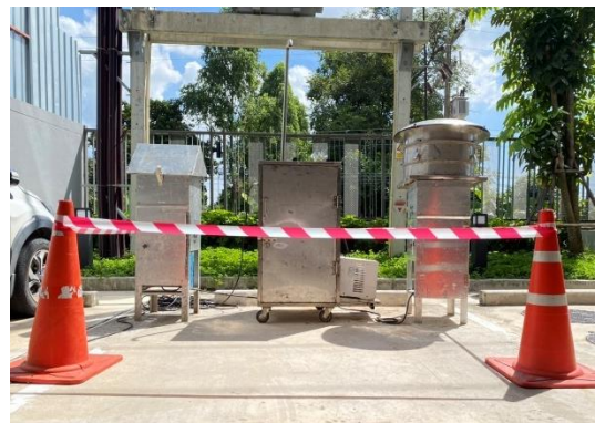
รูปที่ 3.3 การเก็บตัวอย่างคุณภาพอากาศในบรรยากาศ จุดที่ 2 บริเวณพื้นที่อาคารชุดพักอาศัย Kensington Rayong 2
