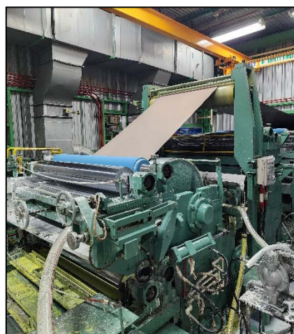
ภาพที่ 2.2-7 กระบวนการเคลือบสีลงแผ่นเหล็ก
