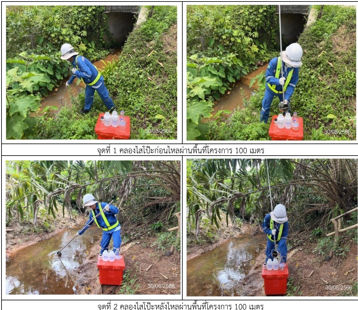
รูปที่ 1.5.2-12 การเก็บตัวอย่างคุณภาพน้ำผิวดิน
