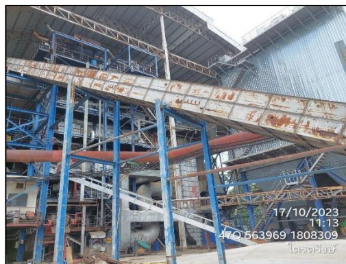
ภาพที่ 6 ระบบสายพานลำเลียงกากอ้อยแบบปิด
