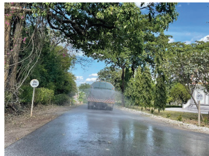
รูปที่ 2-14: การฉีดพรมน้ำบริเวณหน้าเหมืองและเส้นทางลำเลียงแร่
