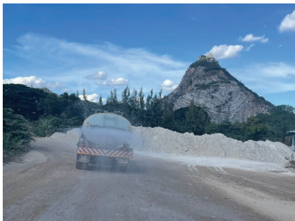
รูปที่ 2-14: การฉีดพรมน้ำบริเวณหน้าเหมืองและเส้นทางลำเลียงแร่
