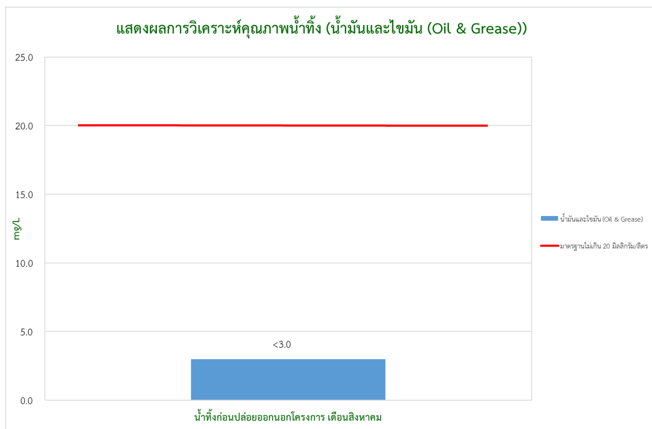
ภาพที่ 3.2.1-3 (ต่อ) กราฟแสดงผลการตรวจวิเคราะห์คุณภาพน้ำทิ้งก่อนปล่อยออกนอกโครงการเดือนสิงหาคม
