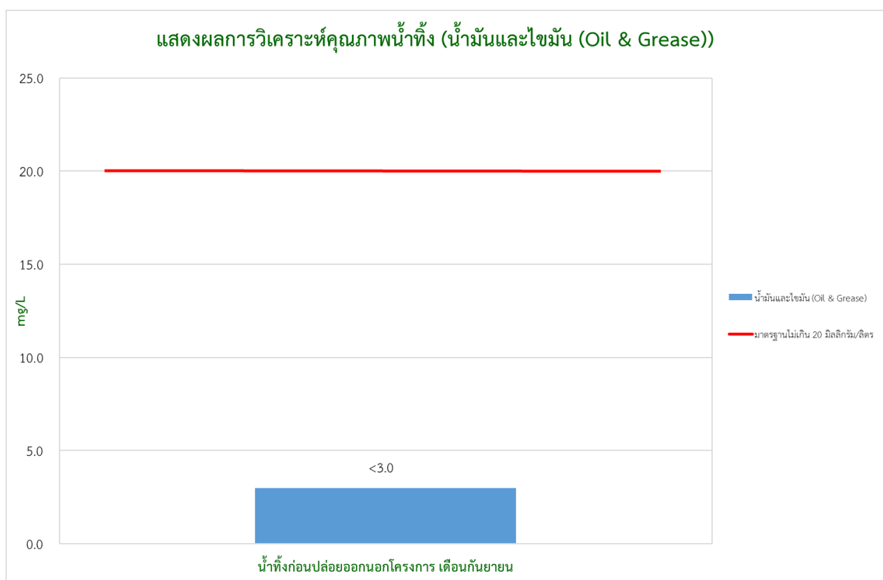
ภาพที่ 3.2.1-4 (ต่อ) กราฟแสดงผลการตรวจวิเคราะห์คุณภาพน้ำทิ้งก่อนปล่อยออกนอกโครงการเดือนกันยายน
