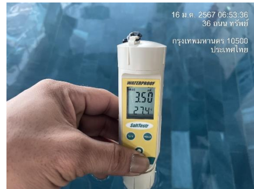
ภาพที่ 3.4-6 การเก็บตัวอย่างคุณภาพน้ำสระว่ายน้ำประจำวัน
