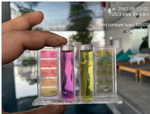
ภาพที่ 3.4-6 การเก็บตัวอย่างคุณภาพน้ำสระว่ายน้ำประจำวัน
