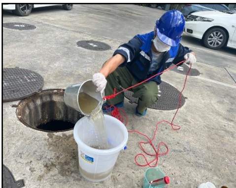
รูปที่ 3.4-5 การตรวจวัดคุณภาพน้ำทิ้ง บริเวณที่ตรวจวัด : น้ำเสียก่อนเข้าระบบบำบัดน้ำเสีย อาคาร B
