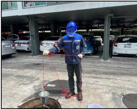
รูปที่ 3.4-4 การตรวจวัดคุณภาพน้ำทิ้ง บริเวณที่ตรวจวัด : น้ำทิ้งที่ผ่านการบำบัดจากระบบบำบัดน้ำเสีย อาคาร A
