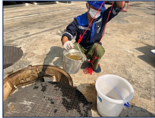
รูปที่ 3.4-4 การตรวจวัดคุณภาพน้ำทิ้ง บริเวณที่ตรวจวัด : น้ำทิ้งที่ผ่านการบำบัดจากระบบบำบัดน้ำเสีย อาคาร A
