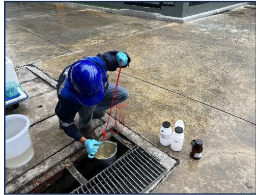
รูปที่ 3.4-7 การตรวจวัดคุณภาพน้ำทิ้ง บริเวณที่ตรวจวัด : บ่อพักน้ำสุดท้ายก่อนระบายออกนอกโครงการ
