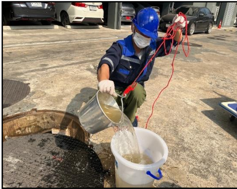
รูปที่ 3.4-3 การตรวจวัดคุณภาพน้ำทิ้ง บริเวณที่ตรวจวัด : น้ำเสียก่อนเข้าระบบบำบัดน้ำเสีย อาคาร A
