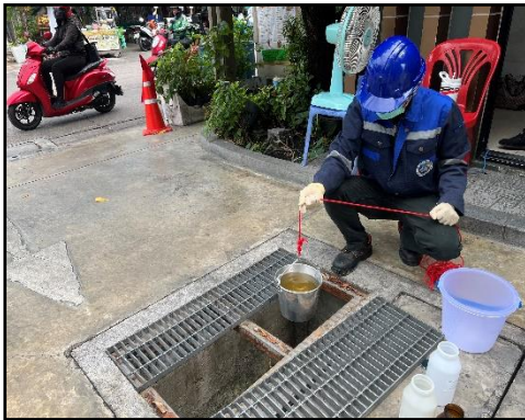
รูปที่ 3.4-7 การตรวจวัดคุณภาพน้ำทิ้ง บริเวณที่ตรวจวัด : บ่อพักน้ำสุดท้ายก่อนระบายออกนอกโครงการ
