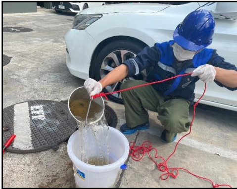
รูปที่ 3.4-6 การตรวจวัดคุณภาพน้ำทิ้ง บริเวณที่ตรวจวัด : น้ำทิ้งที่ผ่านการบำบัดจากระบบบำบัดน้ำเสีย อาคาร B
